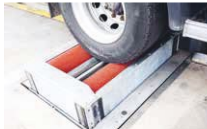
VERSCHLEISSARME ROLLEN Dank aufgeschweißter ProfiOberfläche.
