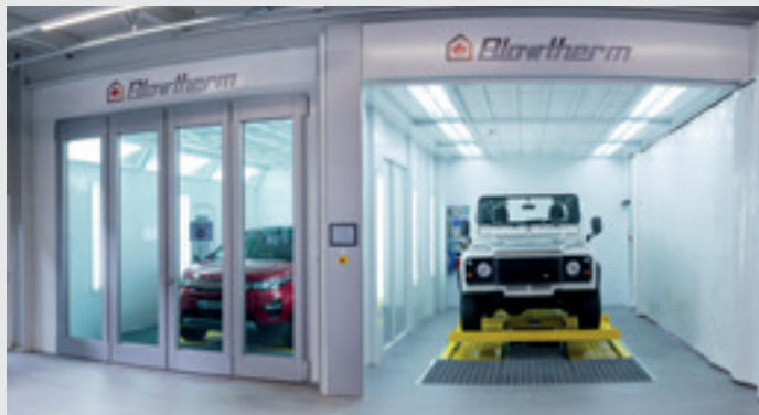
Lackierkabine mit 4-flügligem Tor und Füllerplatz mit Hebebühne - geplant von unseren Spezialisten.
