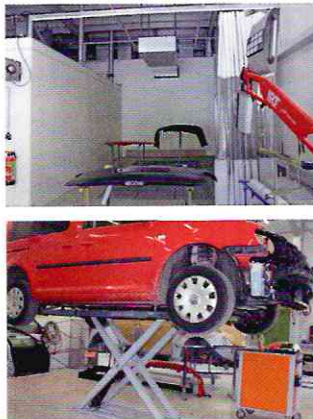
Effizienzsteigerung: Füllerplatz neben der Lackierkabine, Car-O-Liner Scherenbühne mit Richtaufsatz
